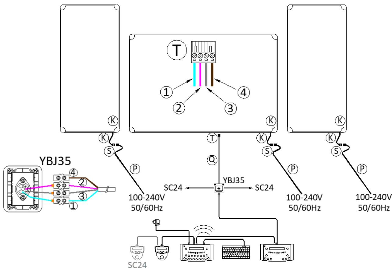
Câble de contrôle (Q) : (1) = GND = fil bleu / (2) = Rx+ = fil blanc / (3) = Rx- = fil gris / (4) = +24V = fil transparent
