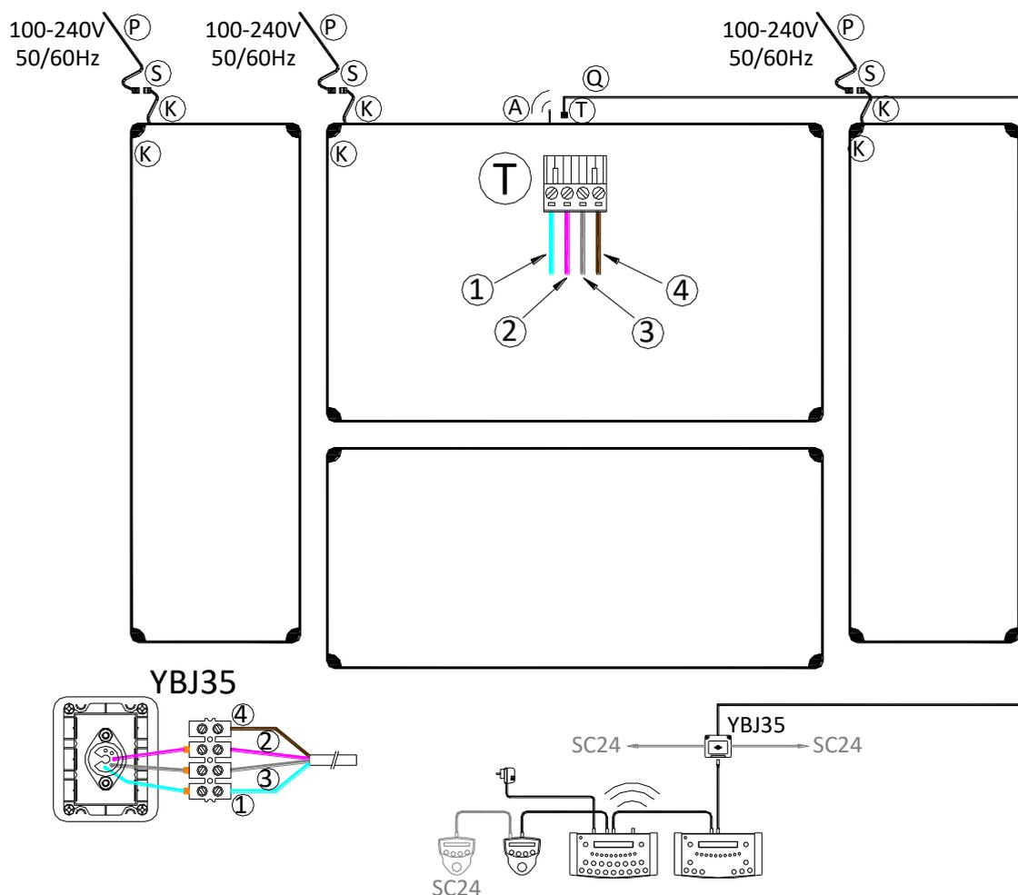
Câble de contrôle (Q) : (1) = GND = fil bleu / (2) = Rx+ = fil blanc / (3) = Rx- = fil gris / (4) = +24V = fil transparent
